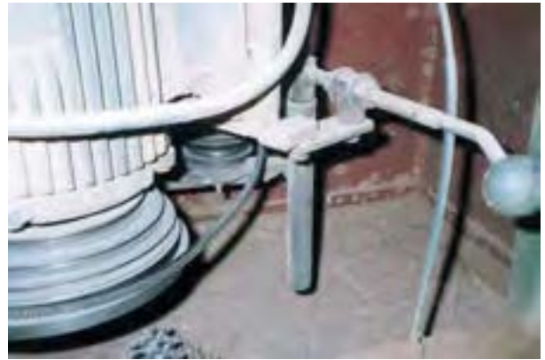
شکل ۱۱-۶- خارج کردن تسمه از پولی.
