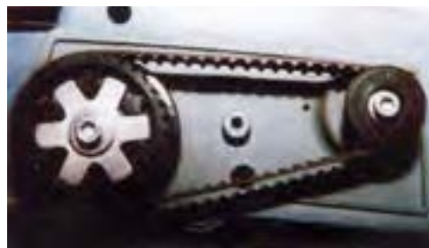
شکل ۹-۱۴- وضعیت قرار گرفتن تسمه روی پیرغ‌دنده.
