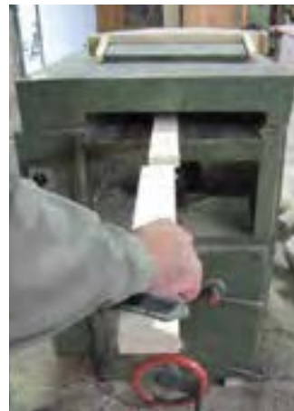
شکل ۷-۳۲ - روش صحیح وارد کردن چوب.
