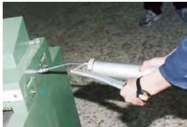
شکل ۸-۱- گریس‌کاری بلبرینگ یاتاقان‌ها.
