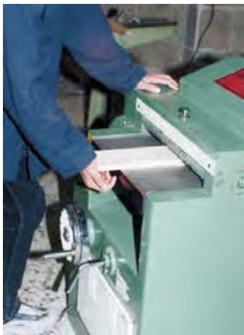
شکل ۷-۴۲- روش ایمنی هدایت چوب به داخل ماشین.
