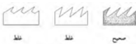
شکل ۱-۶۸-۱- فرم‌های مختلف تیز شدن ته دندانه.
