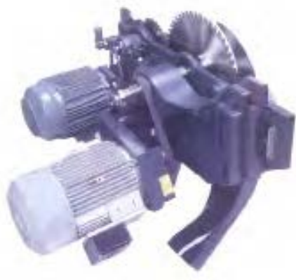
شکل ۱۲-۷- الکتروموتور و سیستم انتقال نیرو.
