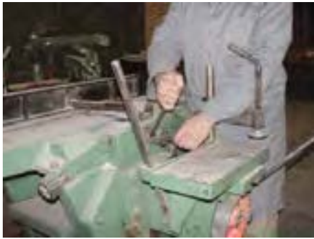
شکل ۹-۱۲- قرار دادن مته در سه نظام.
