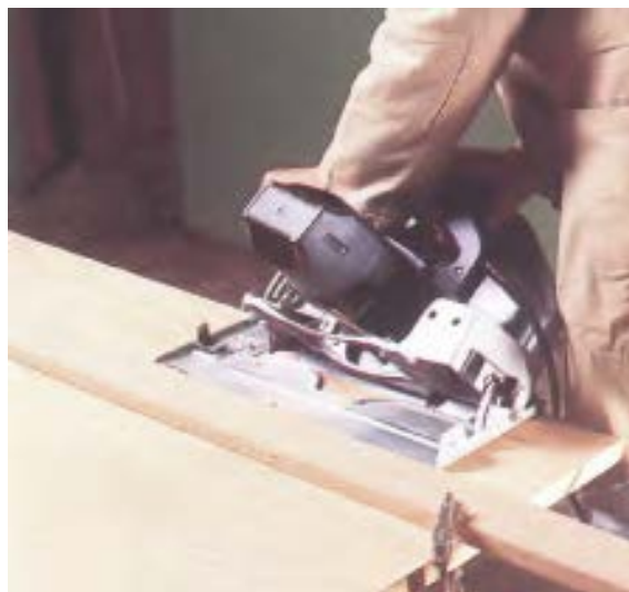
شکل ۱۳-۱۲ صفحه‌ی دستگاه تمت زاویه تنظیم شده است.
