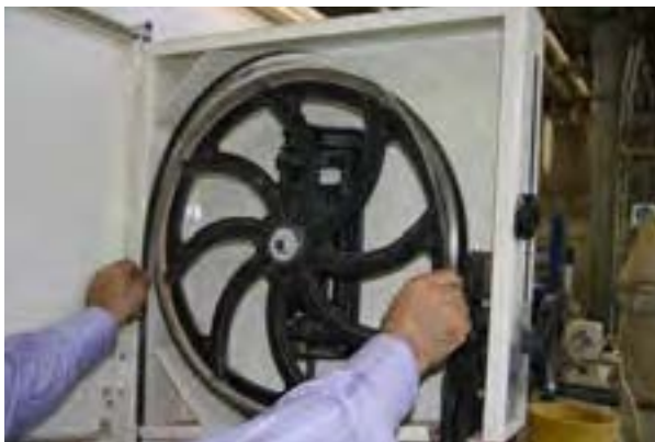
شکل ۱۴۹-۱ برقراری تیغه روی فلک بالا.
