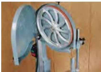
شکل ۴-۲- حفاظ باز شده‌ی روی فلکه و تیغه. تیغه از روی فلکه‌ها خارج شود (شکل ۵-۲).
