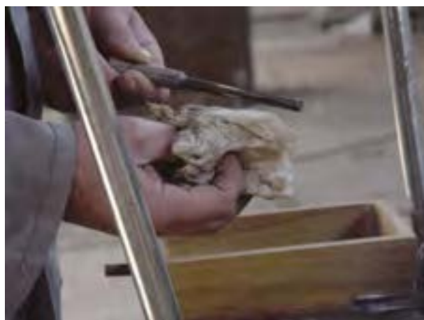
شکل ۱۶-۱۰- تمیز کردن مته‌های خارج شده از ماشین.
