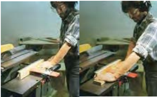
شکل ۱-۴۴-۱- گونیایی کردن چوب قبل از برش.
