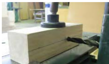
شکل ۹-۱۸- تنظیم نیش مته با فط وسط چوب.
