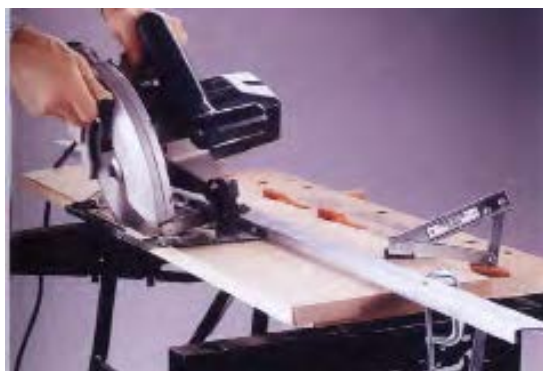
شکل ۱۳-۱۴ برش با استفاده از تکیه‌گاه.
