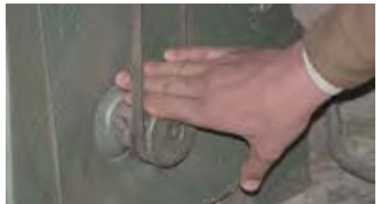
شکل ۶-۵ - مراقبت از انگشتان به هنگام تعویض تسمه.
