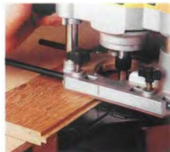
شکل ۱۶-۴. دوراهه زدن، با دستگاه اورفرز.
