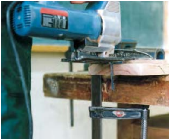
شکل ۱۵-۳۵. صفحه، کاملاً روی چوب قرار نگرفته است.
