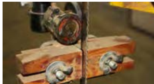
شکل ۳-۲- گریس‌کاری بلبرینگ تیغه ااره.
