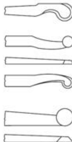
شکل ۱۱-۱۷- مغار(های) مخصوص سطوح مقعر و فضاهای داخلی.
