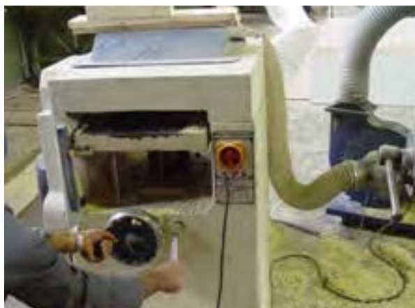
شکل ۷-۴۰- تنظیم دهانه‌ی گندگی.
