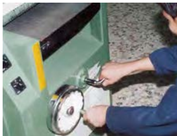
شکل ۱۹-۷- تنظیم صفحه و ممک نمودن اهرم مربوطه.
