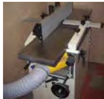
شکل ۴-۲۲ - مکندهی قابل اتصال به ماشین کفرنده.
