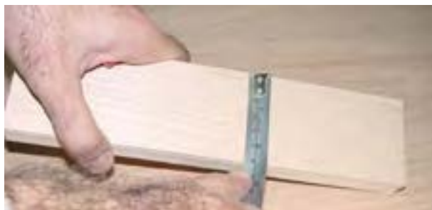
شکل ۳۶-۷- اندازه‌گیری نهایی قطعه کار.
