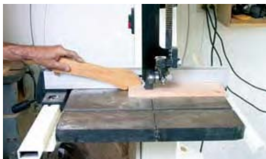
شکل ۱-۵۵- ۱- برش چوب‌های باریک به وسیله‌ی چوب کمکی. توجه کنید که برش به انتها نزدیک شده است.
