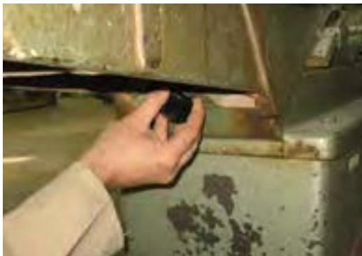
شکل ۹-۴- اهرم ثابت کننده‌ی صفحه.
