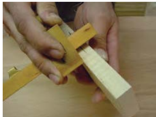
شکل ۹-۱۵- تعیین وسط نر چوب به وسیله‌ی فکاش تیره‌دار.
