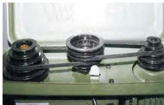
شکل ۱۹-۱۳- تغییر دور پله‌ای در دستگاه دریل ستونی.
