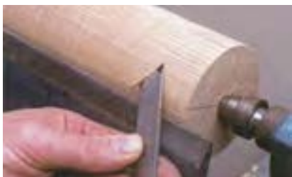
شکل ۱۱-۱۴- مغار مورب برای موج‌گیری و صاف کردن سطوح مورب.
