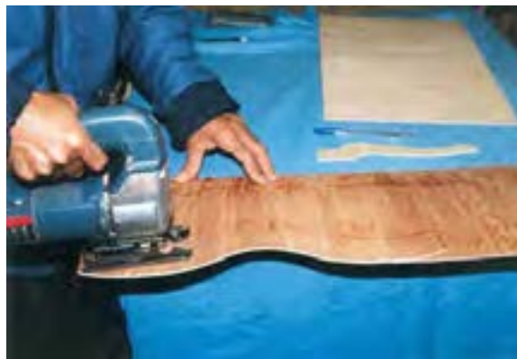
شکل ۲۱- ۱۸. برش تخته سه‌لایی با توجه به طرح الگو.
