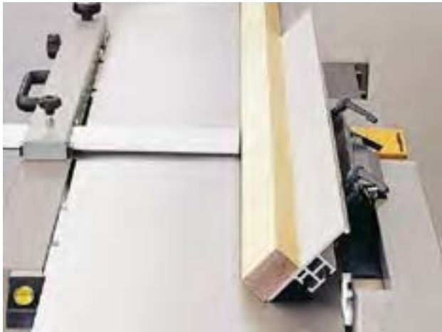
شکل ۴-۲۸ - رندیدنِ تمت (زاویه‌ی چوب، به وسیله‌ی گونیای تمت زاویه‌ی کفرند).
