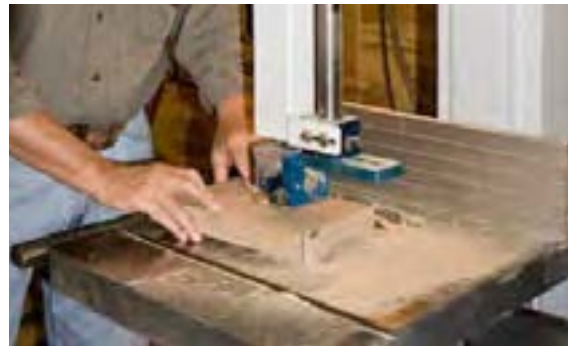
شکل ۱-۳۵- ا- فاصله‌ی ارتفاع سطح چوب با دستگاه هدایت.
