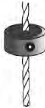
شکل ۱۹-۵۳- قطعه به‌جای میله‌ی عمق سنج.
