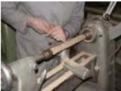
شکل ۱۱-۶۱- گرد کردن کامل قطعه چوب هشت ضلعی.
