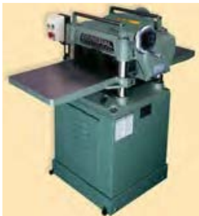
شکل ۱۲-۷ ب - نمونه‌ی قرار گرفتن صفحه‌ی گندگی (روی چهار ستون).
