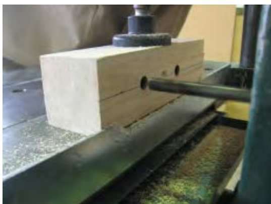
شکل ۹-۲۰- ایجاد سوراخ‌هایی با فاصله‌ی مدود ۲ میلی‌متر از همدیگر.
