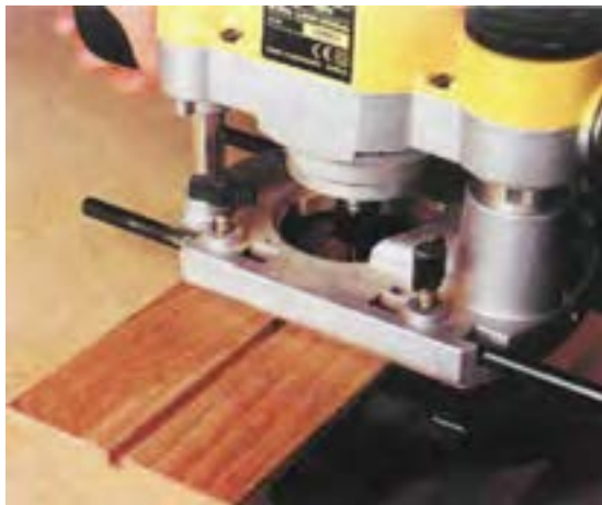
شکل ۱۶-۳. کنشکاف زدن، با دستگاه اور فرز.
