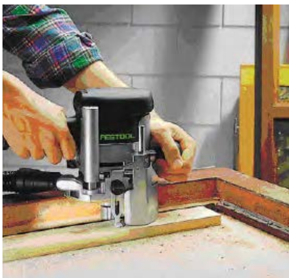
شکل ۱۶-۷- برداشتن قسمت اضافی سه لایی.
