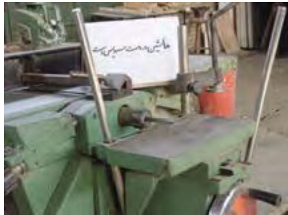
شکل ۱۰-۸- تابلوی هشدار سرویس‌کاری.
