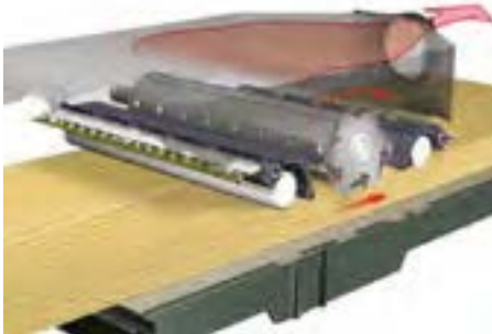
شکل ۸-۷- غلتک آجدار، توپی تیغه‌ها و غلتک صاف.
