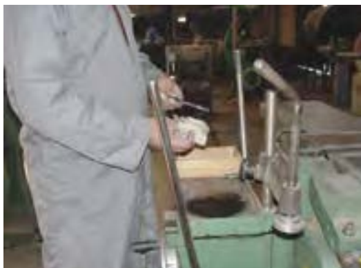
شکل ۱۰-۵- (روغن‌کاری و تمیز کردن مته‌ها).
