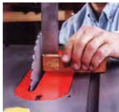
شکل ۱۶-۱۲- کنترل زاویه‌ی تیغه.
