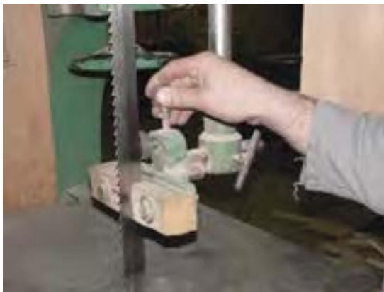
شکل ۵۲-۱- نمونه‌ی تنظیم فاصله‌ی بلبرینگ با پشت تیغه.
