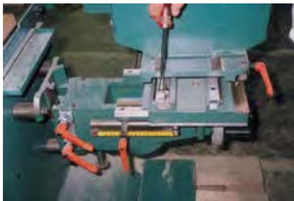
شکل ۱۰-۱۴- کنترل پیچ‌های دستگاه هدایت.
