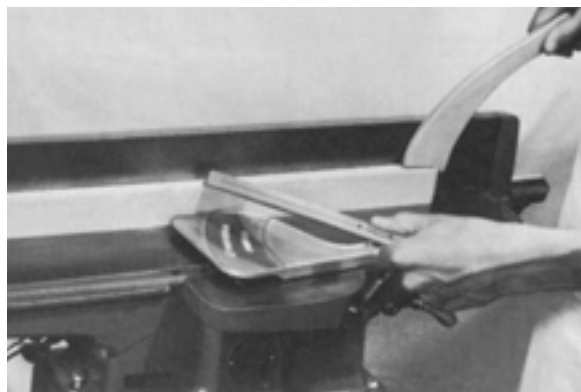
شکل ۱۷-۴-الف - رنده کردن انتهای چوب‌های باریک.
