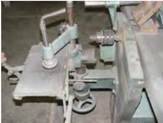
شکل ۲-۹ - ماشین سه‌کاره شامل: کُم‌کنی، رنده و
