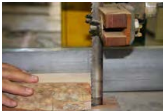
شکل ۳۲-۱- شرایط ایمنی دست، هنگام کار با اره.
