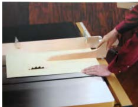
شکل ۱۲-۳۹- استفاده از وسیله‌ی کمکی برای برش تخته سه لایی.
