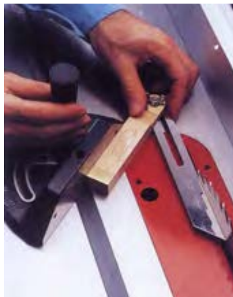
شکل ۲۰-۱۲- تنظیم زاویه‌ی تیغه
