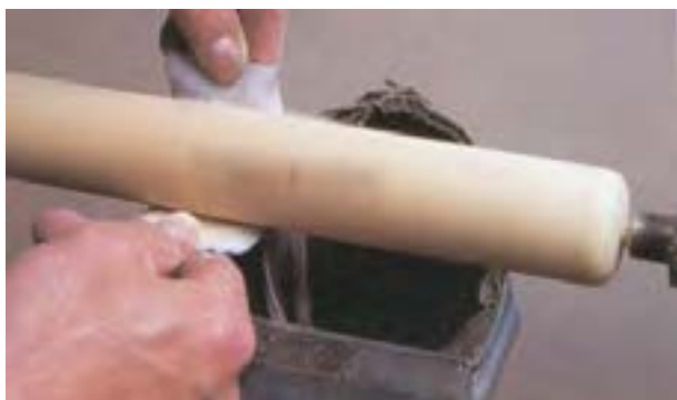
شکل ۱۱-۳۵- به وسیله‌ی سناده‌ی زبر، چوب فرایندی شده پرداخت می‌گردد.
