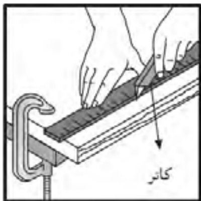
شکل ۲۱-۱۵- تعیین مسیر برش توسط فلکاش و کاتر
