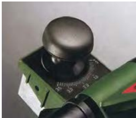
شکل ۴-۱۴. پیچ تنظیم صمفه برای پوشالبرداری
