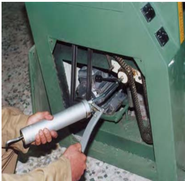
شکل ۸-۷- گریس‌کاری ممبرهای انتقال نیرو.
