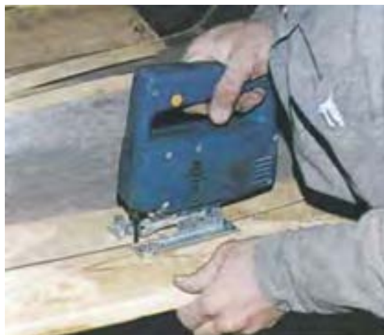
شکل ۱۹-۱۵- برش طولی چوب بدون استفاده از گونیا.
