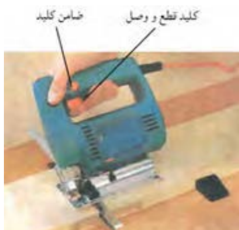
شکل ۱۴-۱۵- کلید قطع و وصل و ضامن کلید.
