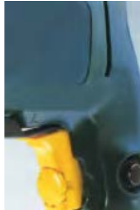
شکل ۱۹-۴۴- دریل با تنظیم دور آهسته و تند.
