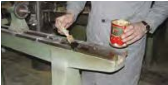
شکل ۱۱-۴۵- تمیزکاری قسمت‌های ضروری و بدون رنگ ماشین.
