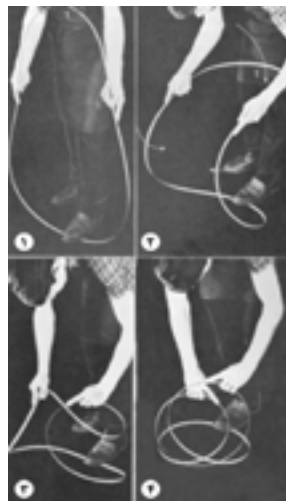
شکل ۷-۳- پگونگی جمع کردن تیغهی اره و تبدیل آن به ۳ ملقه.
