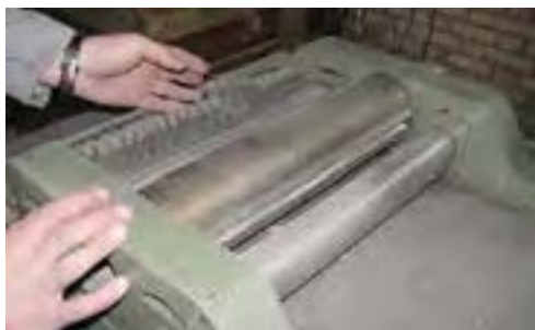
شکل ۲۵-۷. پاک کردن شانه‌ها.
