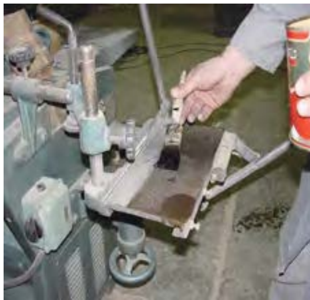
شکل ۱۰-۱۲- چرب کردن صفحات با روغن.
