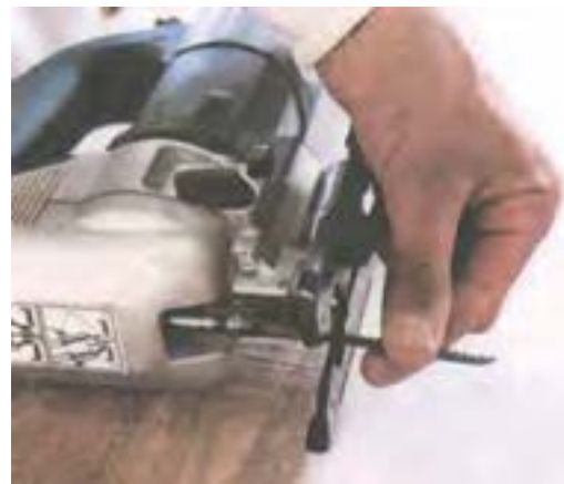
شکل ۱۵-۴۱- تعویض تیغه اره.
