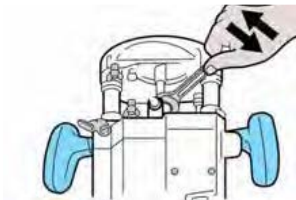
شکل ۱۶-۲۵- ممک کردن تیغه در کولت.
