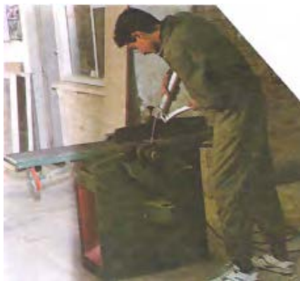
شکل ۱۴-۶- گریس‌کاری یاتاقان‌های توپی رنده.
