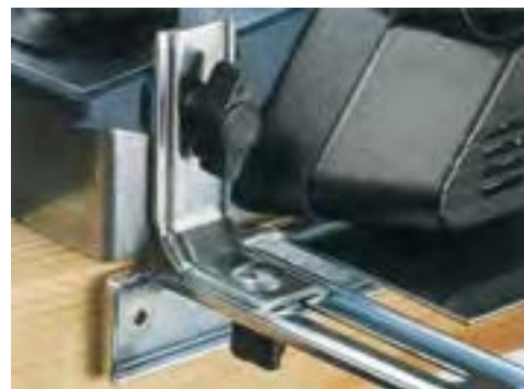
شکل ۱۱-۱۴- نمونه‌ی نصب گونیا به بدنه‌ی رنده (جلو، سمت چپ).
