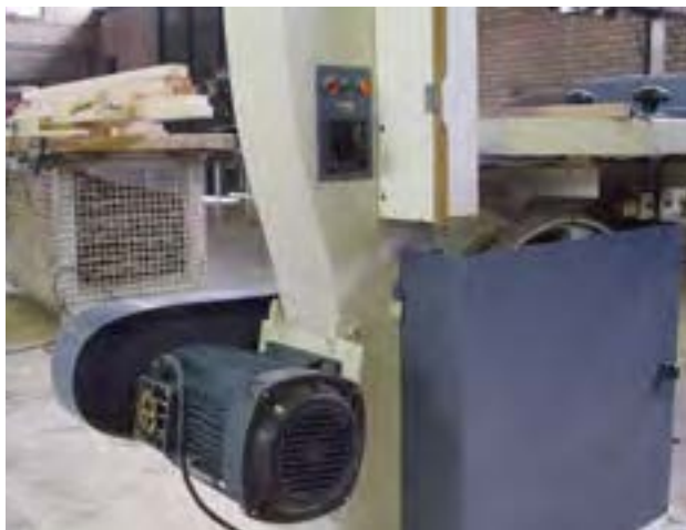
شکل ۲۷- ۱- الکتروموتور تک فاز با هازن راه انداز.
