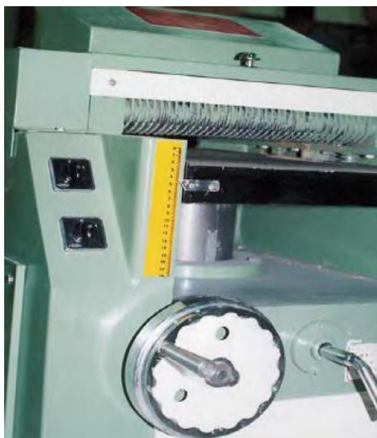
شکل ۷-۴۱- این ماشین، به دو کلید مجهز است.
