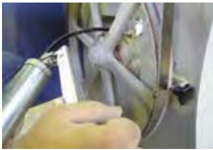
شکل ۳-۳- گریس کاری کتسو جابجایی فلکه‌ی بالا.
