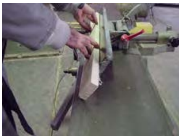
شکل ۴-۳۵. رنده کردن نر چوب با زاویه ۴۵ درجه.
