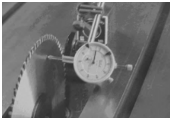
شکل ۱۲-۲۴- کنترل لنگی تیغه با دستگاه لنگی‌سنج.
