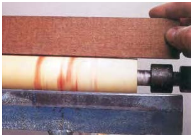
شکل ۱۱-۵۱- کنترل صافی قطعه چوب گرد شده.
