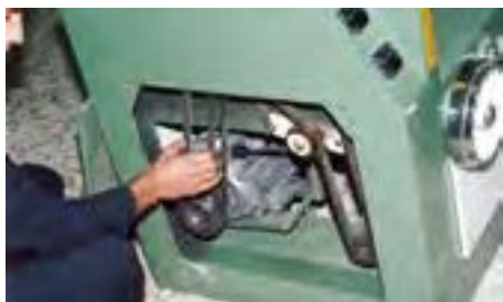
شکل ۲۶-۷. کنترل سفتی تسمه‌ی انتقال نیرو.
