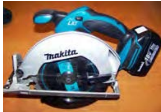
شکل ۱۳-۱- ماشین اره گرد دستی - شارژی.
