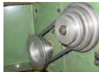
شکل ۶-۱۱- پولی تبدیل دور.
