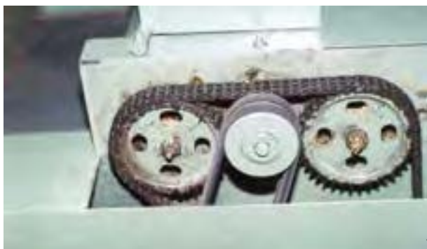
شکل ۱۸-۷. زنجیر انتقال نیرو و قدرت به غلتک‌ها.
