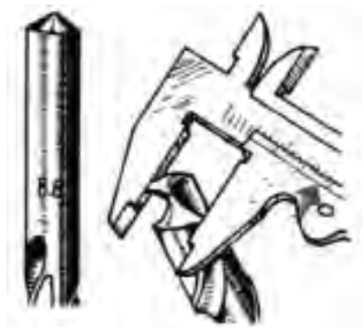
شکل ۱۹-۴۸- اندازه‌گیری قطعه به وسیله‌ی کولیس.
