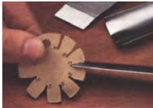
شکل ۴-۵- شابلن مفصوم کنترل زاویه‌ی رنده.
