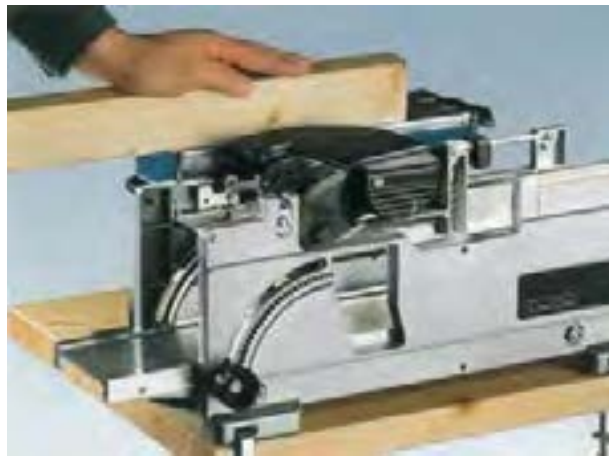
شکل ۱۴-۲۰- کاربرد میز کمکی در موقع رندیدن.
