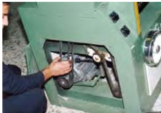
شکل ۸-۸- کنترل مقدار کشش تسمه‌ها.
