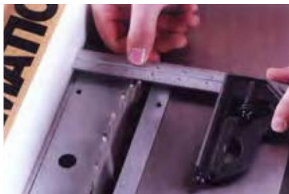
شکل ۱۹-۱۲- تنظیم فاصله‌ی تیغه تا گونیا.
