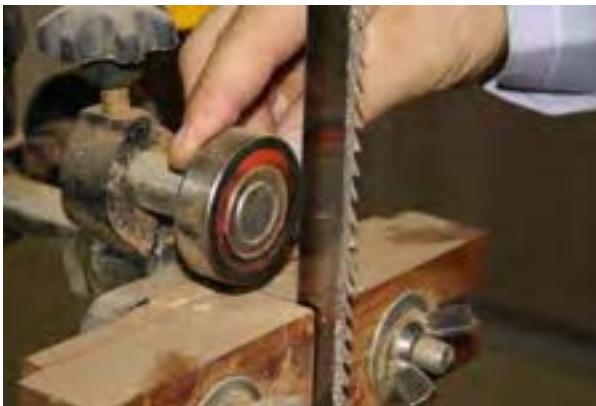
شکل ۳۰-۱- کنترل بلبرینگ پشت تیغه.
