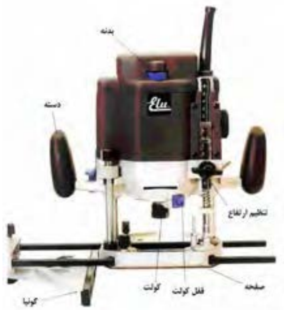
شکل ۱۶-۸- قسمت‌های مختلف دستگاه اورفرز.
