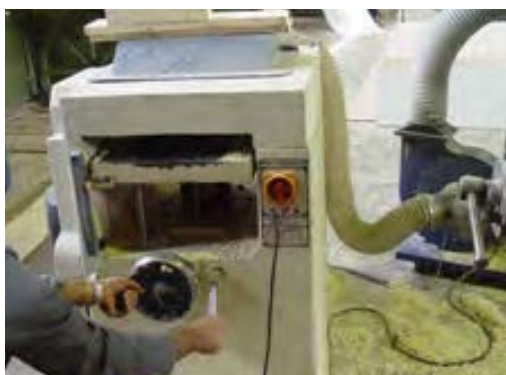
شکل ۷-۴۶- تنظیم بار تیغه به اندازه‌ی مورد نیاز.
