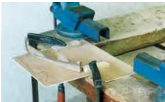
شکل ۴۶-۱۵- قطعه کار، با روشی درست و با گیره دستی روی میز محکم می‌شود.
