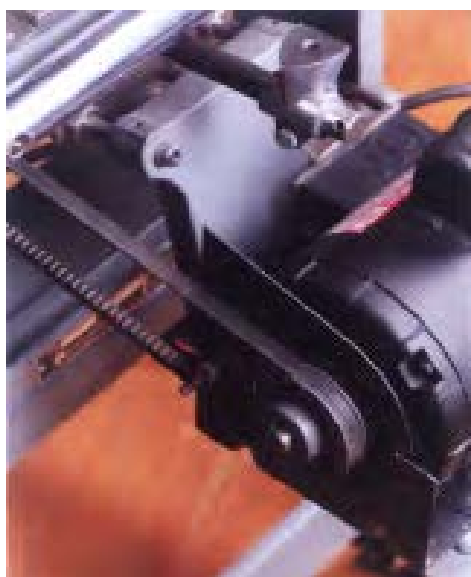
شکل ۱۲-۳۳- تسمه‌ی انتقال نیرو و حرکت.
