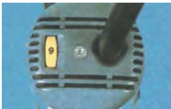
شکل ۵-۱۵- پیچ تنظیم دور، در یکی از مدل‌های اره عمودبُر.
