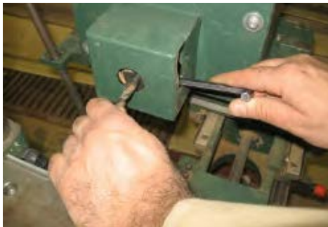
شکل ۹-۱۷- ممکن کردن مته داخل سه‌نظام.
