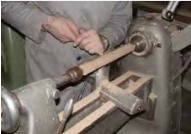
شکل ۱۱-۲۷- نمونه‌ی قرار گرفتن مغار گلوبی هنگام فراطی.
