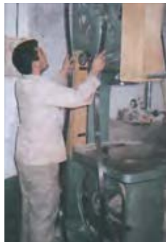
شکل ۱۰-۲- نمونه‌ی خارج کردن تیغه اره.
