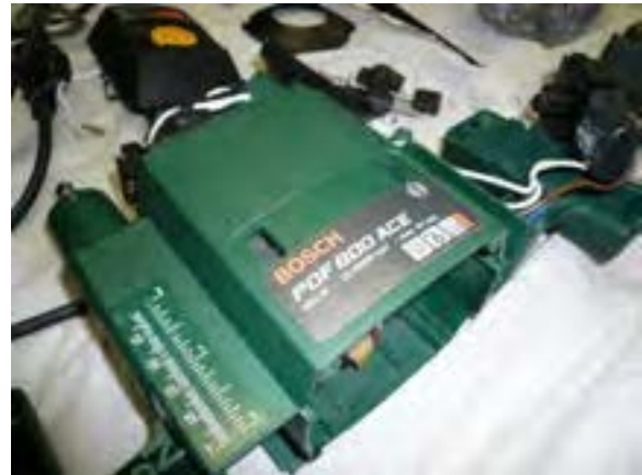
شکل ۱۶-۹- بدنه یا جلد دستگاه اورفرز.
