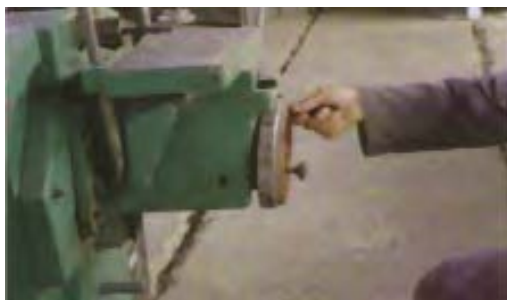
شکل ۱۰-۳- میله و سیستم تنظیم ارتفاع صفحه‌ی متمرک.
