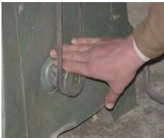
شکل ۱۰-۶- مراقبت از انگشتان به هنگام تعویض تسمه.
