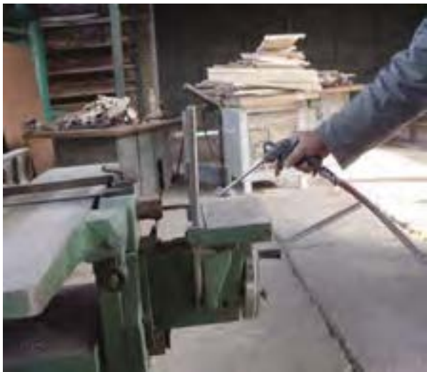
شکل ۱۰-۱۱- غبارگیری قطعات ماشین.
