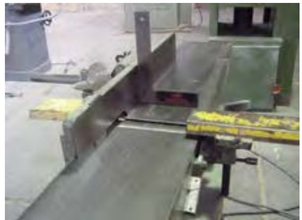
شکل ۳۰-۴- کنترل گونیا ماشین.
