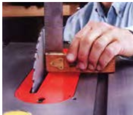
شکل ۱۲-۲۲- کنترل و تنظیم گونیا‌یی بودن تیغه.
