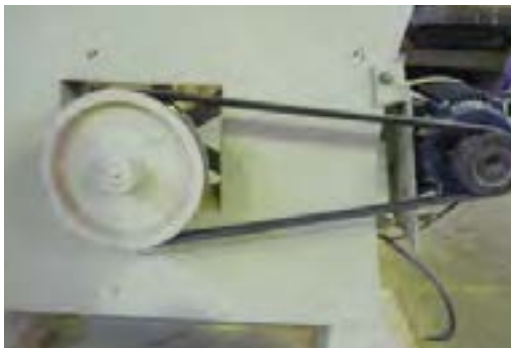
شکل ۳-۱۷- استقرار تسمه در داخل چرخ تسمه.
