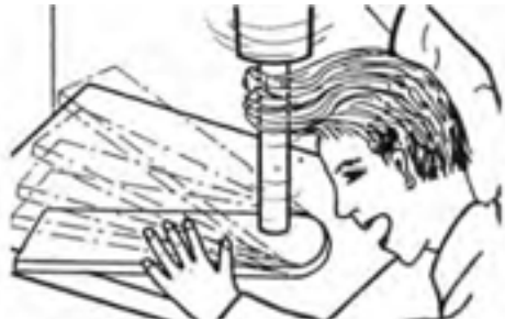
شکل ۱۹-۲۶- درگیر شدن مته با موی سر.
