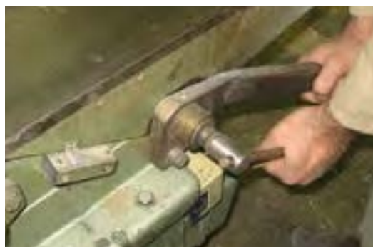
شکل ۱۳-۵- تنظیم مقدار بار.
