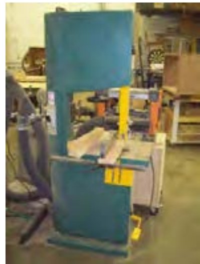
شکل ۹-۱. یک ماشین اره‌نواری، با مفاظ کامل.
