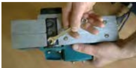
شکل ۱۴-۲۳- خارج کردن تیغه‌ها از جایگاه.
