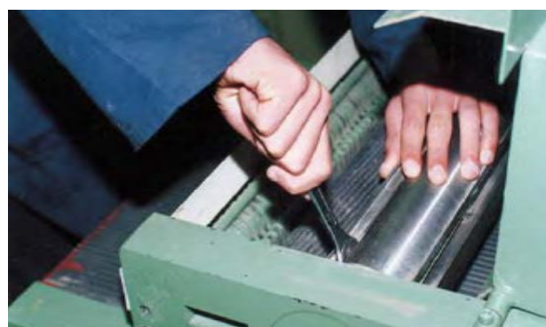
شکل ۲۴-۷. نمونه‌ی بستن تیغه‌ها به توپی.
