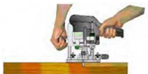
شکل ۱۶-۲۶- دوراهاه (زدن قطعه کار با دستگاه اورفرز).
