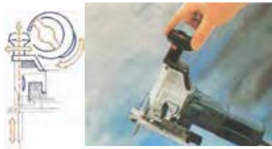
شکل ۱۵-۴۲- تعویض تیغه اره.
