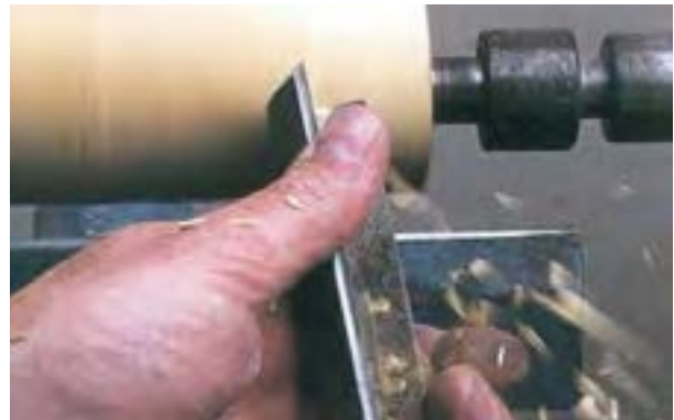
شکل ۱۱-۵۰- گرد کردن نهایی چوب با مغار گلوئی.
