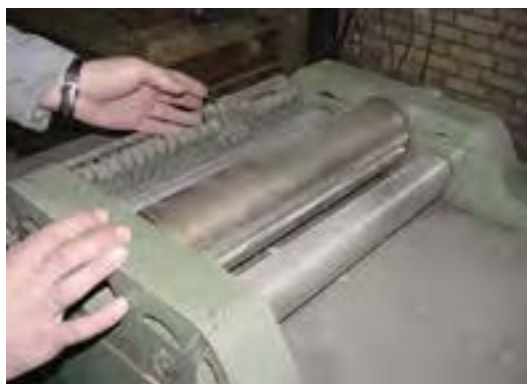
شکل ۷-۲۹- کنترل تمیزی شانه‌ها.
