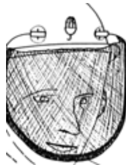
شکل ۱۱-۱۹- در هنگام عملیات فراطی، باید از عینک و ماسک مخصوص استفاده کرد.
