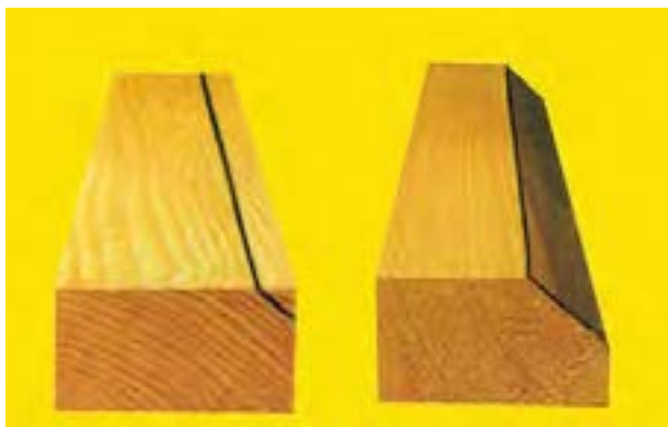
شکل ۳۰-۱۴- چوب فطاکشی شده و پیغ فوره. فط ترسیمی، تا آفرین لمظه باقی می‌ماند.
