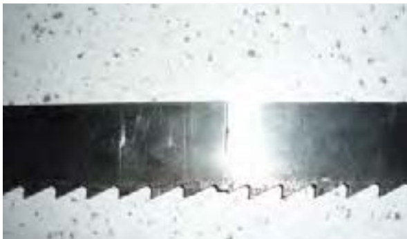
شکل ۷۰-۱- ترک تیغه اره از محل جوش.
