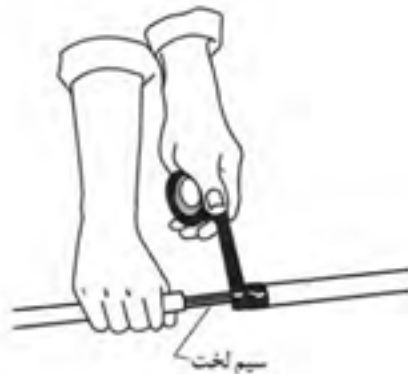
شکل ۱۹-۲۸. پوشش با چسب برق.
