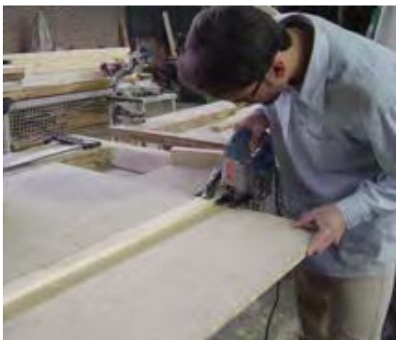
شکل ۱۸-۱۵- نمایی از برش طولی چوب، با کمک چوبی کاملاً صاف.
