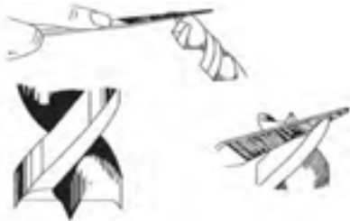
شکل ۹-۱۳ - در صورت کُند بودن مته‌ها، باید آنها را با ابزار مناسب تیز کرد.
