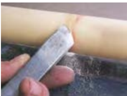
شکل ۱۱-۱۵- مغار نیم‌گرد، برای موج‌گیری و صاف کردن سطوح.
