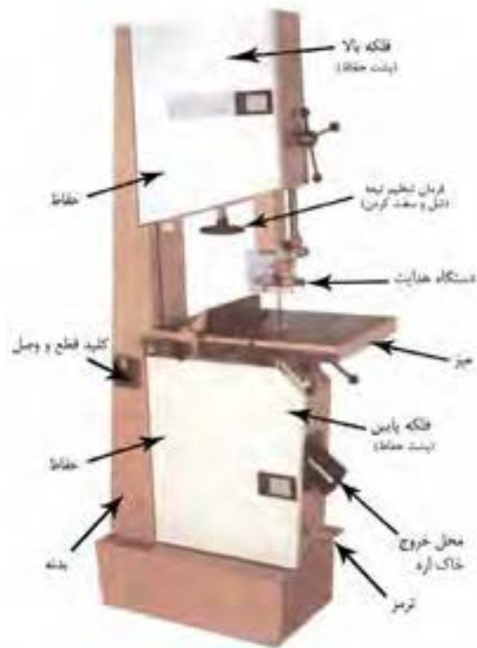
شکل ۴۱-۱. قسمت‌های مختلف یک ماشین اره‌نواری.
