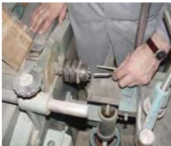
شکل ۱۰-۷- خارج کردن مته از سه‌نظام.
