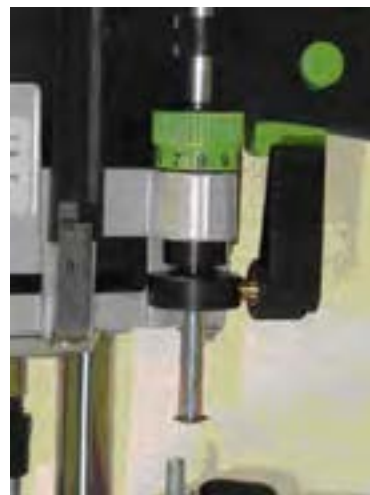
شکل ۱۳-۱۶- درجه‌ی تعیین ارتفاع تیغه.
