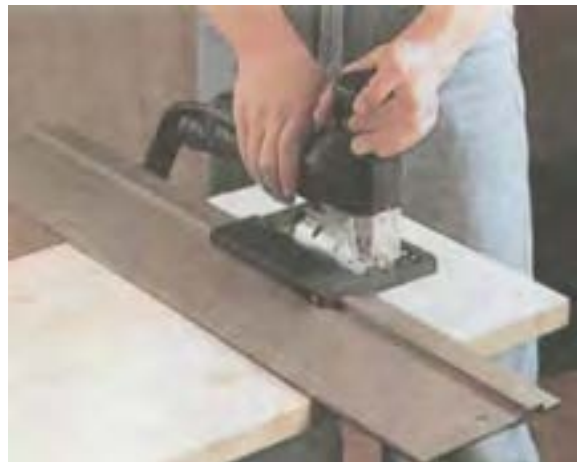
شکل ۲۰-۱۵- برش عرضی چوب به کمک ریل راهنما.
