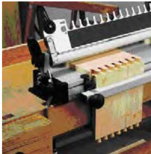
شکل ۱۶-۵- اتصال دم چلچله و انگشتی.
