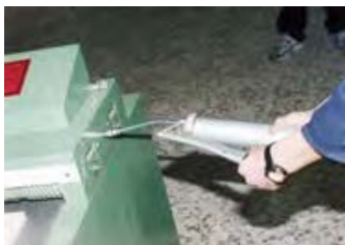
شکل ۸-۱۳- گریس‌کاری یاتاقان‌های ماشین.
