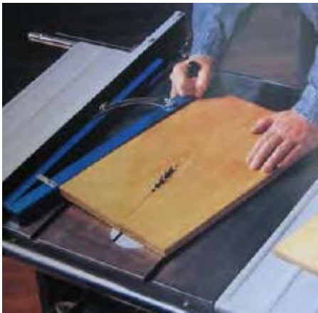
شکل ۱۲-۲۹- برش مورب با ابزار کمکی.
