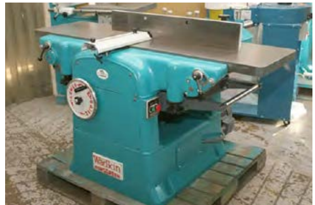
شکل ۴-۴- ماشین کفرند با بدنه چدنی.
