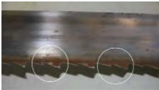
شکل ۱-۶۷-۱- فاصله (گام) دندانه‌ها کم و زیاد شده است.
