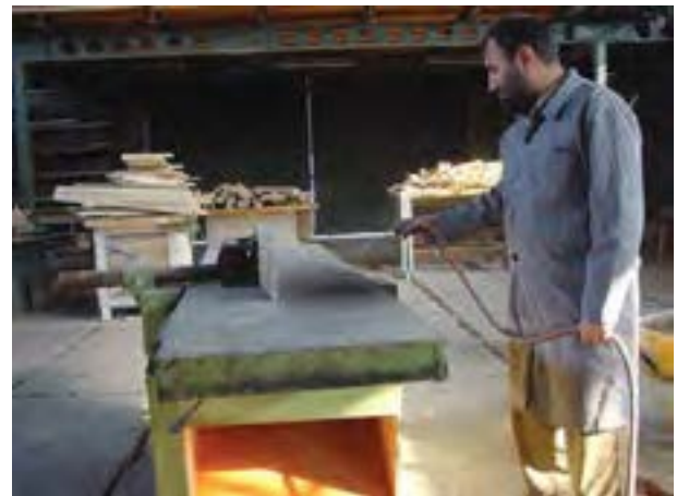
شکل ۱۲-۶- غبارگیری ماشین با شیلنگ باد.
