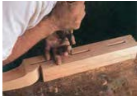
شکل ۹-۲۴- تبدیل گوشه‌های قوسی به چهارگوش، به وسیله مغار یا اسکنه.
