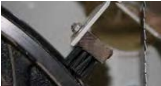
شکل ۸-۱- برس غبارگیری روی بانداژ فلکه.
