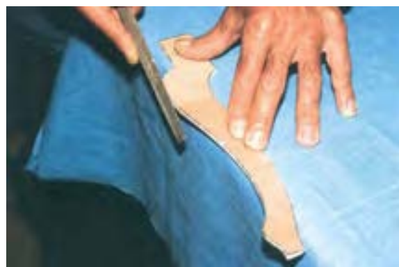
شکل ۲۲- ۱۸. نمونه‌ی پرداخت کردن مسیر برش.
