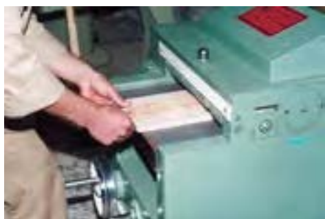
شکل ۳۷-۷- نمونه‌ی زدنیدن چوب نازک.
