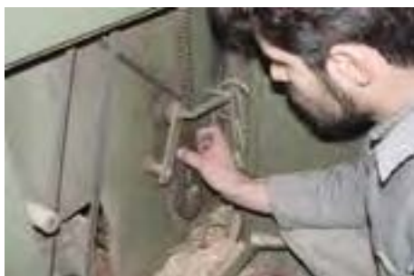
شکل ۲۷-۷. تنظیم و آزمایش سفتی زنجیر انتقال نیرو.
