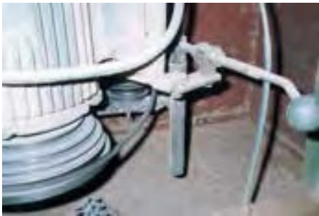
شکل ۳-۱۵- اهرم الکتروموتور، آزاد است.
