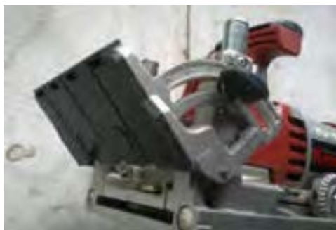
شکل ۴-۱۷- گونیا‌ی یک دستگاه فرز بیسکویتی.
