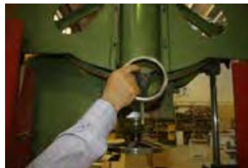
شکل ۷-۲- تنظیم لبه‌ی تیغه اره با لبه‌ی فلک توسط فرمان مربوطه.
