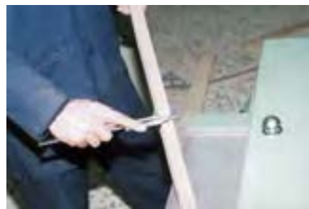
شکل ۴۸-۷- کنترل ضخامت چوب گندگی شده، با کولیس.
