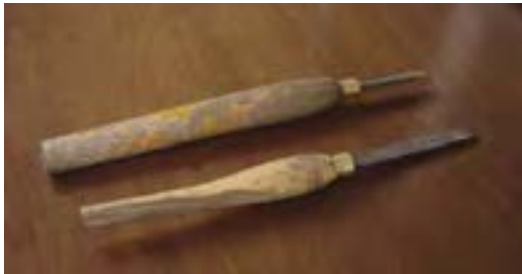
شکل ۱۱-۲۰- نمونه‌ای از مغارهای با دسته‌ی معیوب.
