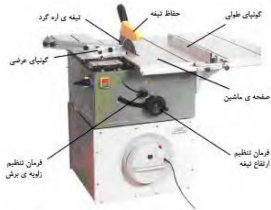
شکل ۱۲-۱ ماشین اره گرد میزی یا مجموعه‌ای.
