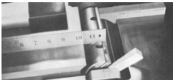
شکل ۱۲-۵. ثابت کردن تویی رنده با یک قطعه چوب در کنار تویی.
