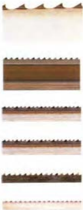
شکل ۱۴۸-۱. فرم‌های مختلف دندانه‌ی اره‌نواری.
