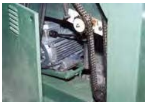
شکل ۸-۱۴- باز کردن درپوش برای روغن‌کاری.
