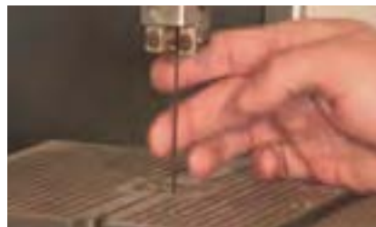
شکل ۱۸-۱- کنترل و بررسی سلامت تیغه و چپ و راست آن.
